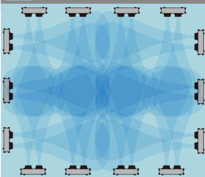
TYPE 2 施設内で一方方向の気流をつくり、熱気を留めない循環をつくる
