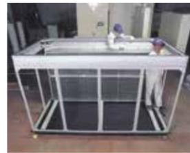
コイル取り付け後、フレーム及びキャンバダクトを取り付けます。
