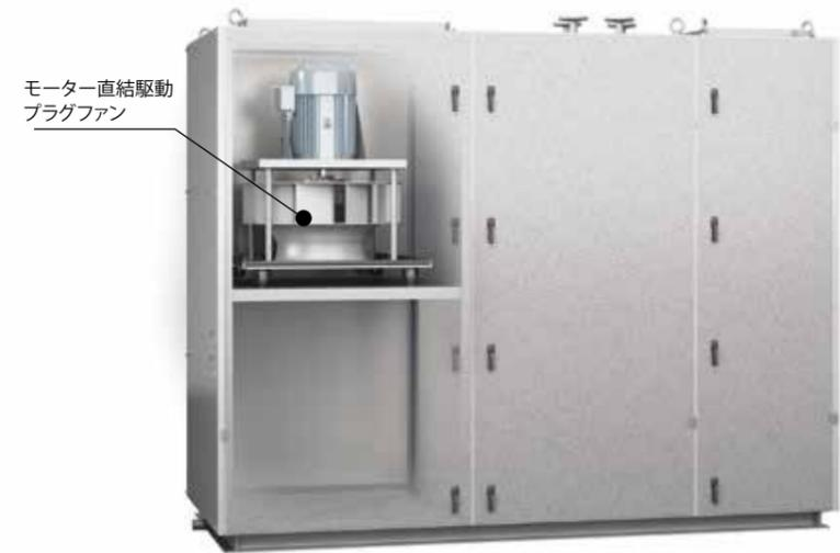
高効率プラグファンを搭載した省スペース・省工事・省エネルギーな空調機です。コイル電動弁、インバーター動力盤を内蔵することで現場の工期短縮に貢献できます。用途に合わせてベルト駆動シロココファンを搭載することも可能です。
