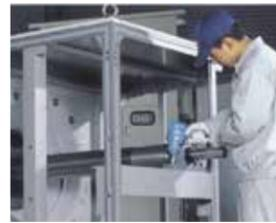
全てのフレームセット後、パネルをビスで取り付けます。最後にモーターを取り付け、組み立て完了です。
